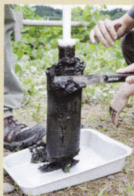
4 凍り付いていないところを、へらでざっくり切り落とす
